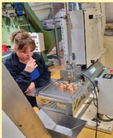
UTILISATION SYSTÉMATIQUE DE LA TECHNIQUE DITE DU "SNIFFING"
